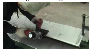
Edge bevelling in S/S
